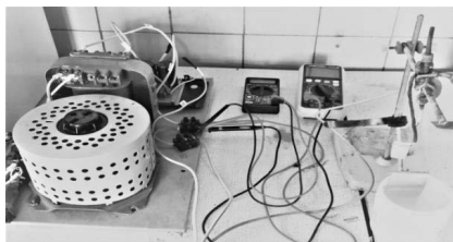
Рис.1 Общий вид лабораторной установки электроплазменной полировки.
