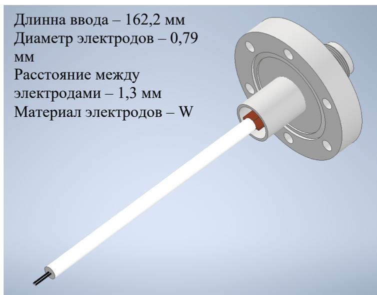
Рис. 2. Трехмерная модель двойного зонда Ленгмюра
